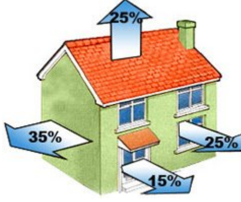
Binada ısı kaybı
