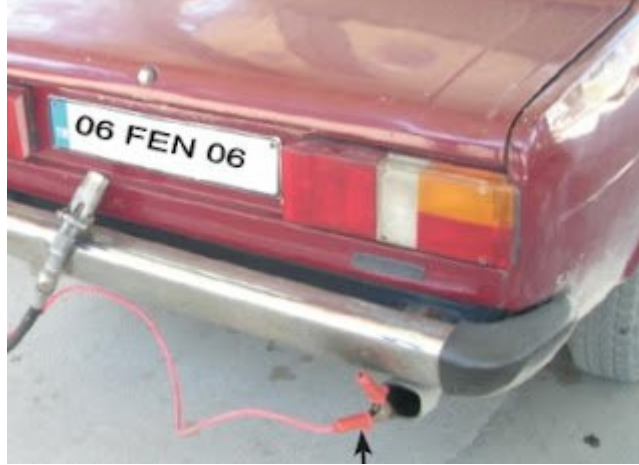
LPG dolumu sırasında topraklama
