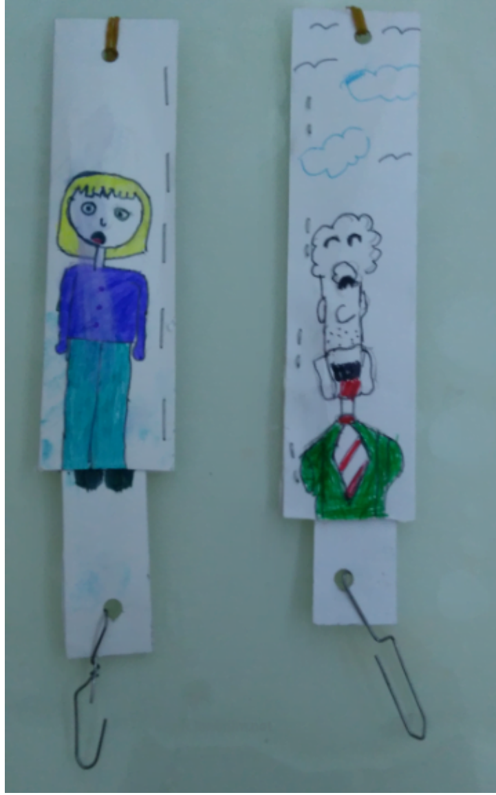
Tek paket lastiđi ile yapılmıř kađıt dinamometre
